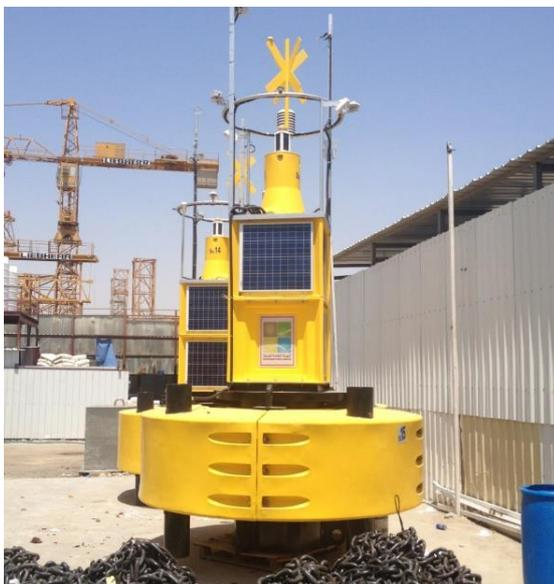
**Рисунок 4 – Внешний вид прибора автоматическая морская станция MicroStep-Mis в буйковом исполнении**
